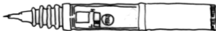
圖二十三、 高壓檢電棒，可切換高低壓檢電鈕。 檢測範圍低電壓 15-65V，高電壓 200-2000V
