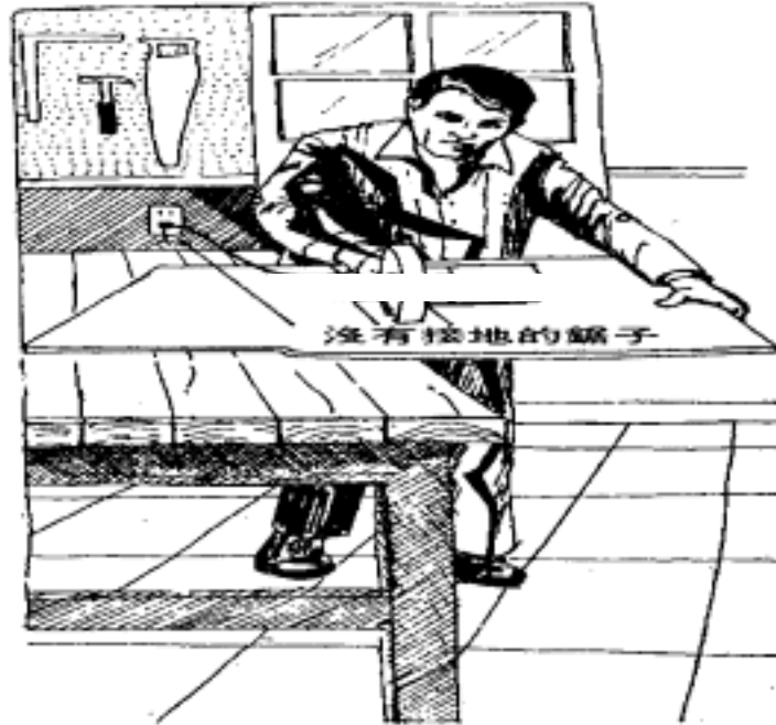
圖三十九、 圓盤鋸線路未正確接地，機具漏電時易引起感電。
