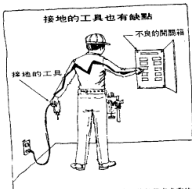
圖四十一、 工具雖具接地功能，如系統線路接地不完全，機具漏電時仍有感電可能。
