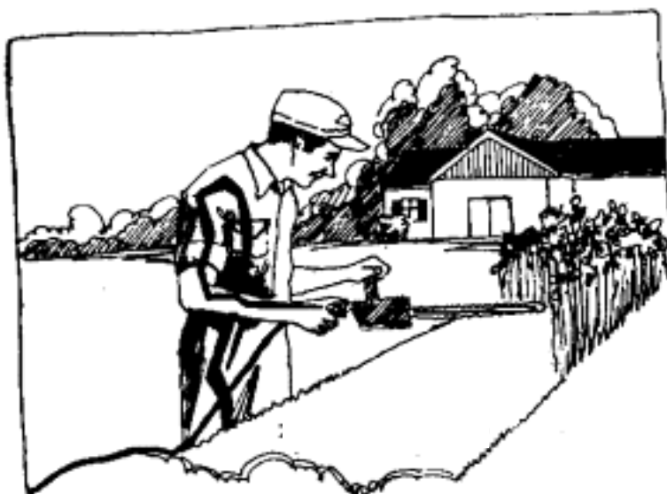
圖三十八、屋外濕草地使用電動機具，潮濕狀況下，機具漏電時易引起感電。
