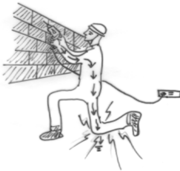
圖三十七、狹隘空間下作業，人體膝蓋與大地或設備底部接觸，電氣器具漏電時易造成感電迴路。
