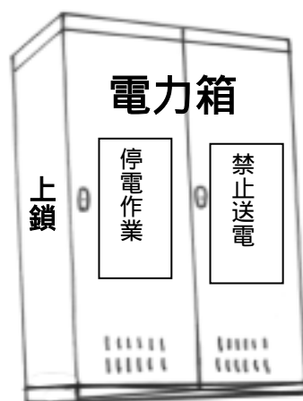
圖二十一、電力箱可上鎖時的停電作業標示
