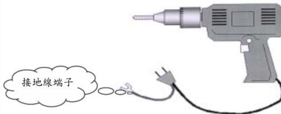
電動機具線路接地方式
